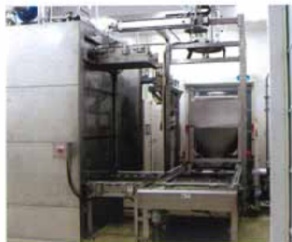
～自動倉庫と連結したコンテナ自動洗浄装置～
