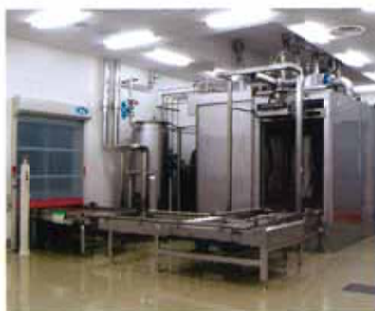
～自動倉庫と連結したコンテナ自動洗浄装置～
