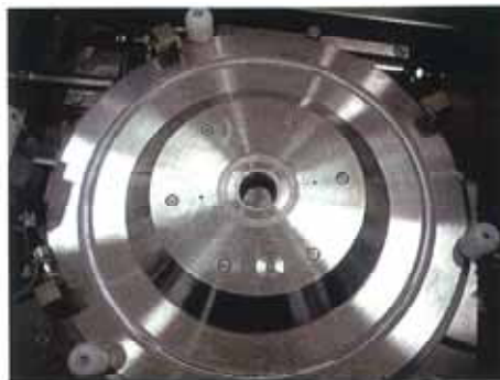
●BPK4 排出ステーション上面
